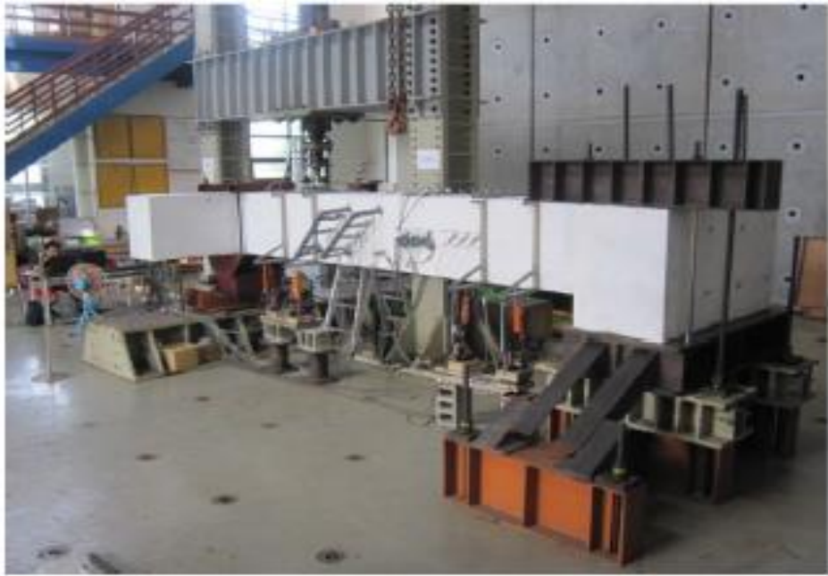
Kutu kesitli betonarme kiriş burulma deneyi
