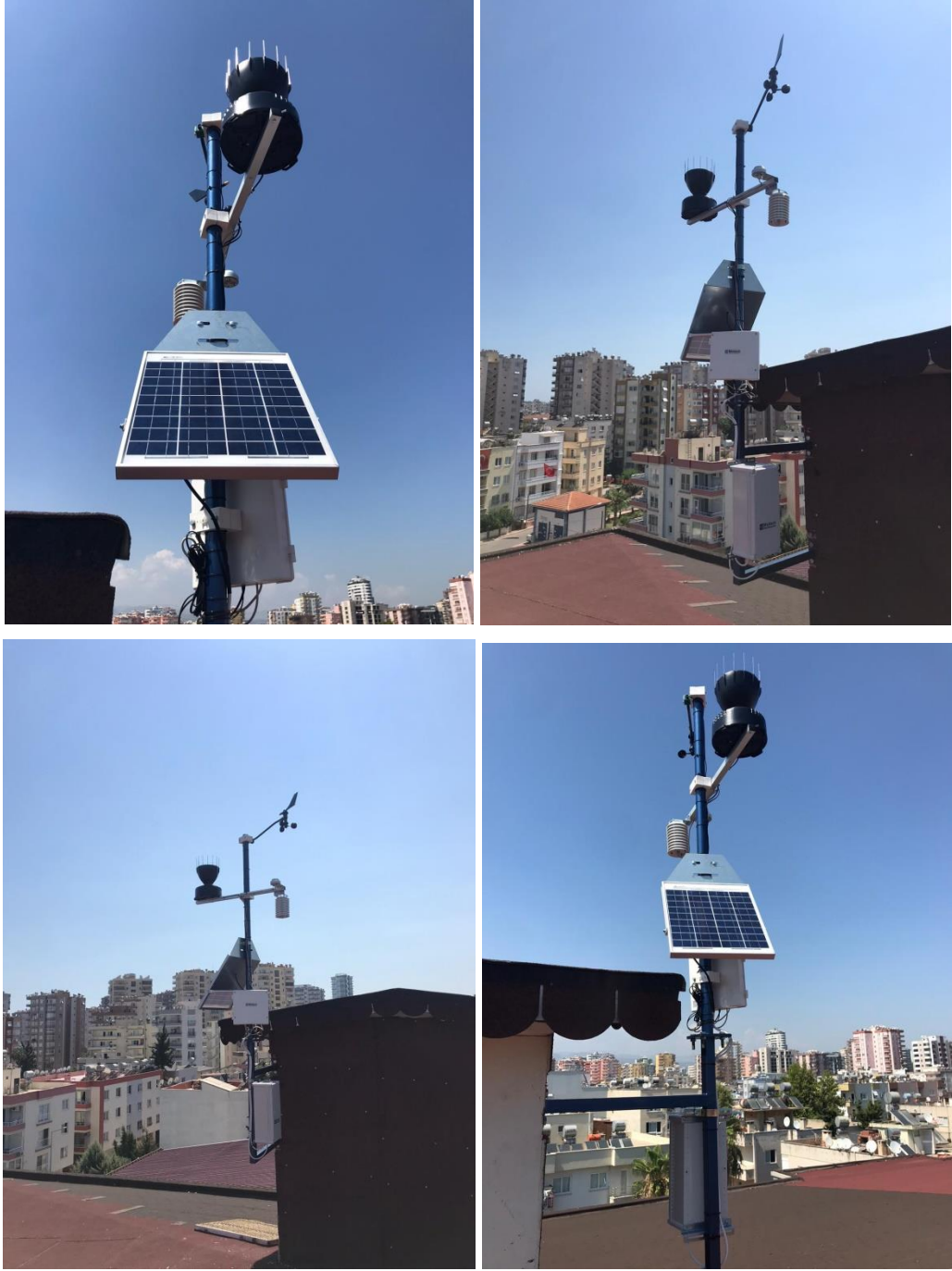
Şekil 5. 11.1131 Model Mottech Solar İstasyonu
